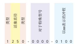
例如: 直径25mm、冲程100mm的ZS气缸的货号
